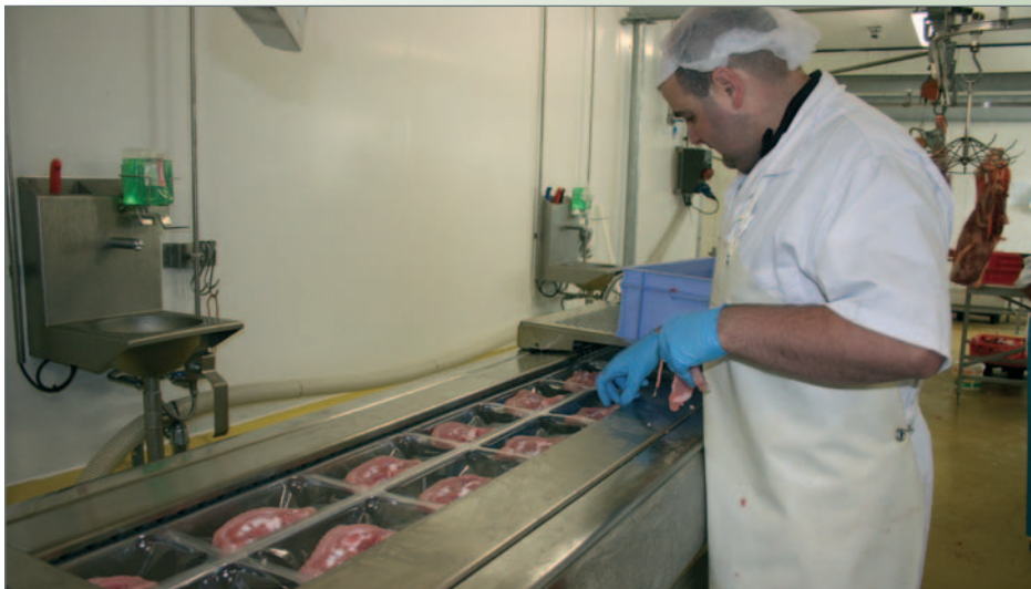
L'emballage des pièces découpées s'effectue avec la nouvelle thermoformeuse automatisée.
