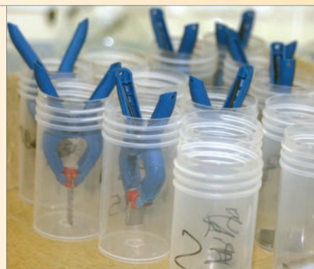
Plan d'expérience en vue de la détermination des conditions optimales de dégraissage sur des plaques d'acier.
