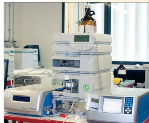
L'AS-FLFFF, ou Asymétrical flow field flow fractionation, sert à séparer en taille, en masse et en fonction de la lumière les éléments étudiés.
