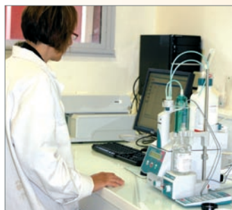
Dans les locaux d'UT2A, on procède au dosage de l'acide base des bains grâce à un titreur.
